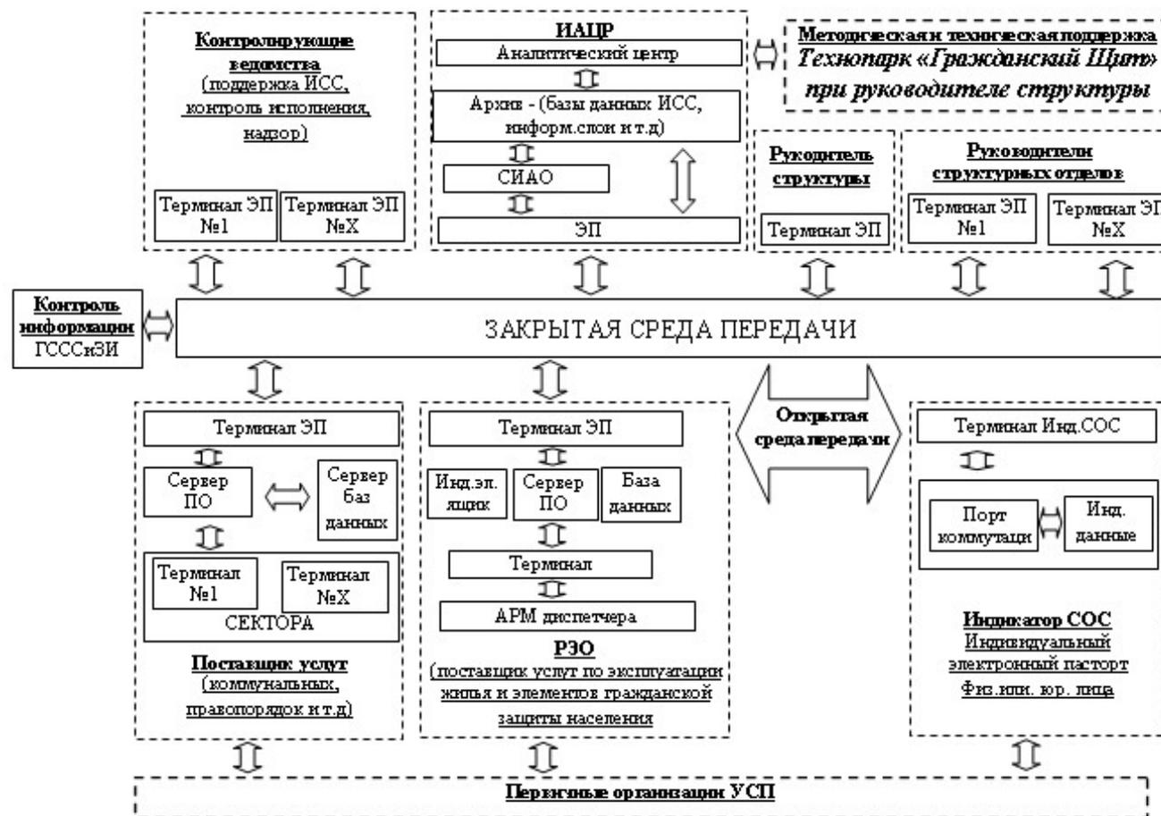
Рис. 1. Структурная схема компонентов и связей АРМ «Гражданский щит»
